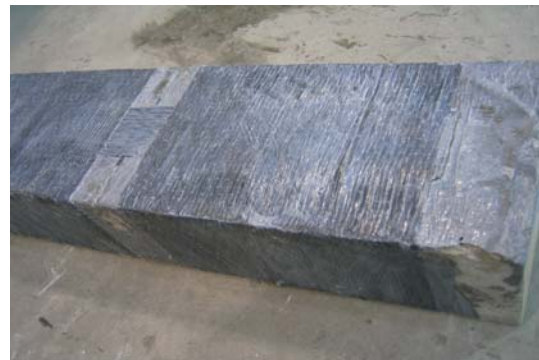
(d) Debonding of CFRP with wrap (beam10)
