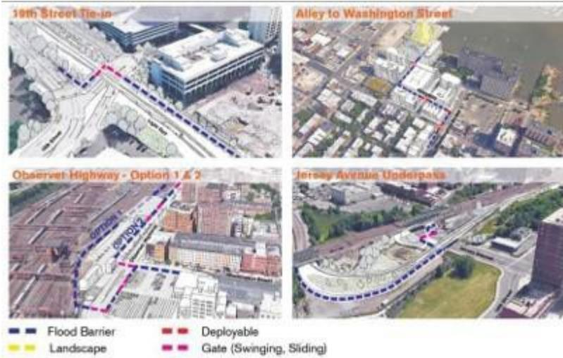
**Fig. 4-17:** Características del trazado de «Resistir» en el Proyecto en cuatro puntos de ubicación.
