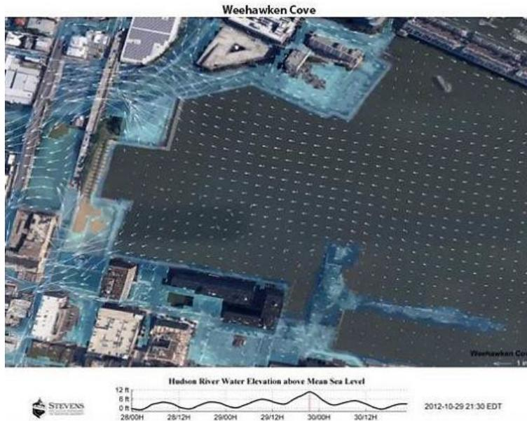
**Fig. 4.5: Modelización de marejadas ciclónicas en la ensenada de Weehawken, NJ.** Al modelizar la interacción entre la superficie terrestre y las vías fluviales durante una marejada ciclónica se vislumbran los efectos que tiene para la seguridad pública, incluso en las rutas de evacuación y la infraestructura crítica. Estos modelos se pueden utilizar para comprender los riesgos locales de las marejadas ciclónicas.
