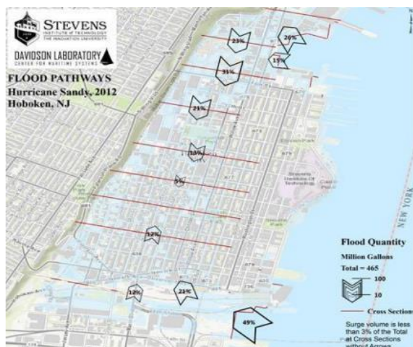
Fig. 4.3: Uso de múltiples fuentes para validar la modelización de inundaciones. En colaboración con el Estado, el Stevens Institute of Technology explora técnicas innovadoras para recopilar datos que fundamenten el análisis de riesgos. Esta fotografía es una de las muchas obtenidas durante y después del huracán Sandy a través del uso de múltiples fuentes. Las fotos con ubicación geográfica y fecha, como esta, permiten al Estado validar las proyecciones del modelo con respecto a puntos de datos verificados, perfeccionando aún más la precisión de la modelización de inundaciones para identificar áreas con mayor vulnerabilidad de inundación.
