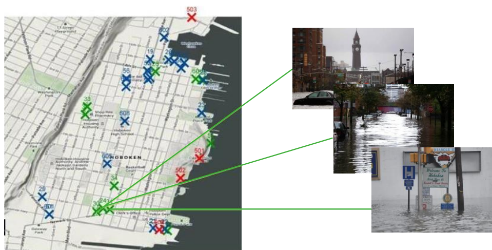
Figura 3-3: Crowd-sourcing o "colaboración abierta distribuida" para validar el modelado de inundaciones. Junto con el Estado, el Stevens Institute of Technology explora técnicas innovadoras para recolectar datos para el análisis del riesgo. Esta fotografía es una de muchas tomadas durante y después del embate del huracán Sandy mediante "crowdsourcing". Las fotografías con identificación del tiempo y las coordenadas geográficas, tal como la de arriba, permiten que el Estado valide las proyecciones del modelo comparándolas con puntos de datos documentados, refinando aún más la precisión del modelado de la inundación para identificar áreas de mayor vulnerabilidad ante las inundaciones. Fuente: Estado de New Jersey en colaboración con Stevens Institute of Technology.
