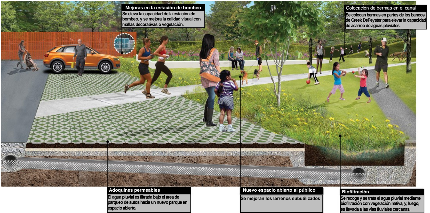
Representación del concepto de mejora potencial del drenaje cerca de la estación de bombeo de Creek DePeyster
