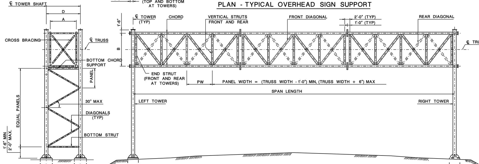
**ELEVATION - TYPICAL OVERHEAD SIGN SUPPORT**
