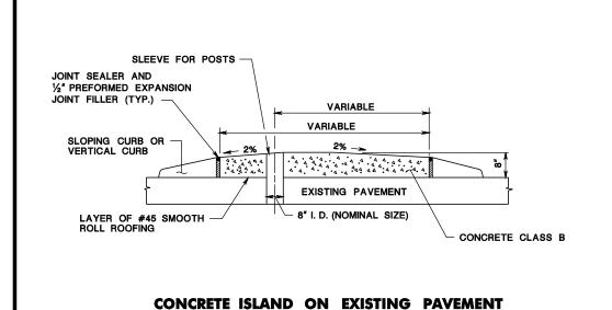
LONGITUDINAL AND TRANSVERSE JOINT TREATMENT FOR CONCRETE ISLAND
